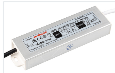
021965 Блок питания ARPV-24045B (24V, 1.88A, 45W), для подключения 2-х метров ленты.
